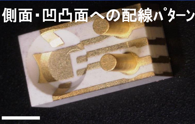
傾斜部への配線パターン(断面)
